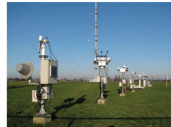
Figuur 2. Foto van het BSRN station in Cabauw (december 2008) met op de achtergrond de 213 m hoge meetmast. Centraal staat de zonnevolger met beschaduwde pyranometers (voor het meten van diffuse straling), een pyrgeometer (neerwaartse langgolvlige straling) en pyrheliometers (directe straling). Verder staan er op de site instrumenten voor het meten van aerosol optische dikte, bedekkingsgraad en wolken-temperatuur, zonneshijnduur en UV straling. Voor meer informatie en quicklooks: [3].
